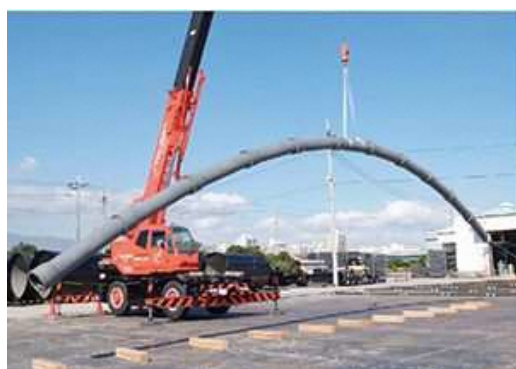
写真4-4 耐震管(GX形ダクトイル铸铁管 (*) ) (写真提供：日本ダクトイル铸铁管協会)
