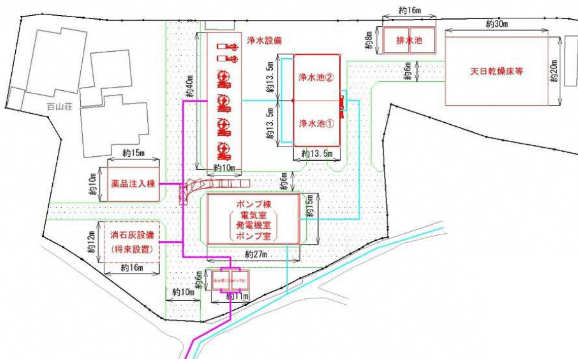
図 4-6 更新後の新浄水場レイアウトイメージ
