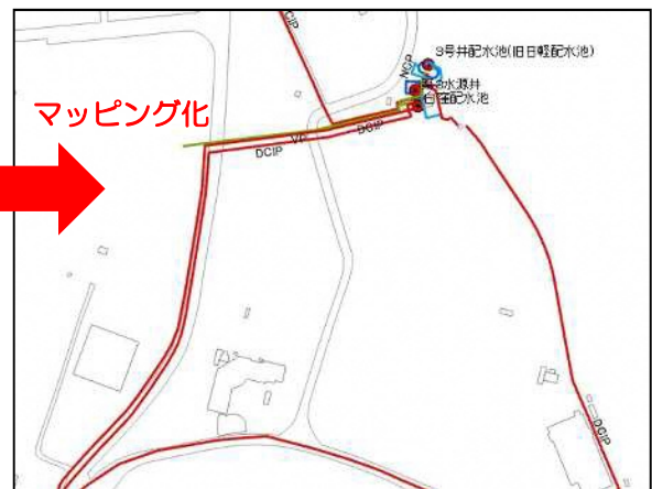
図 4-19 管路図のマッピングデータ（イメージ）
